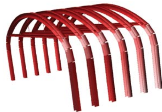
Modelo da estrutura de proteção da abóbada
